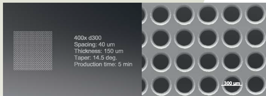
硼硅酸盐玻璃微孔. 样图由FTMC提供.
