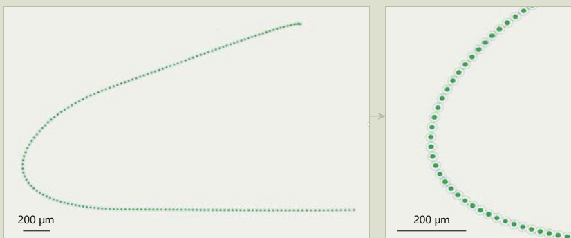
Fig 3. 采用按需脉冲（PoD）和基于位置的激光触发模式扫描复杂形状，间距为30微米，扫描速度为6米/秒。扫描从右上角开始，至右下角区域结束。PoD功能确保在高速下脉冲间距保持一致。
