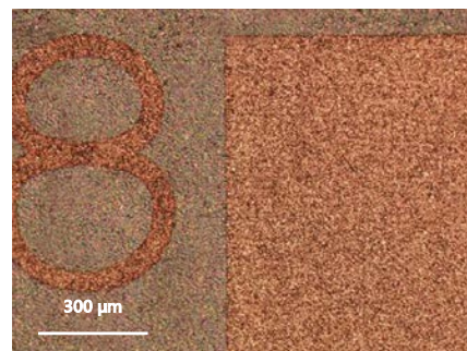
PCB绝缘薄膜去除. 样图由FTMC提供.
